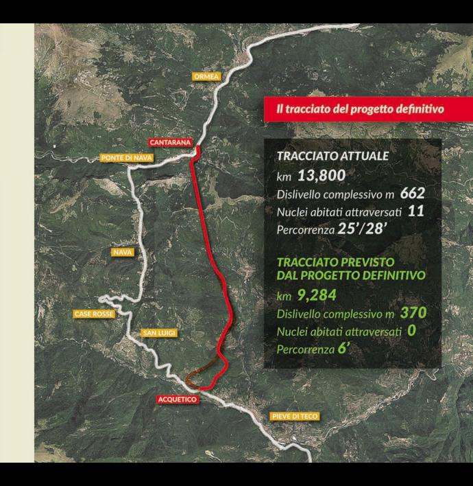
L'intervento si sviluppa per complessivi 9,284 Km, con sezione stradale C1 (D.M. 05/11/2001) di larghezza complessiva pari a 10,50 m:
