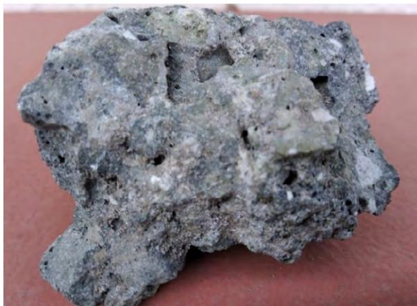
In secondo luogo, si sono evidenziate problematiche anche a livello della combustione del cippato, in quanto si è verificata una produzione di aggregati solidi e stabili in caldaia, che hanno determinato il deterioramento di alcuni componenti, la perdita di efficienza energetica e una generale difficoltà di smaltimento della cenere.
