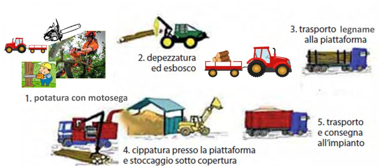
**OPZIONE 2:** potatura con essiccazione in campo della legna, cippatura a bordo strada e trasporto del cippato alla piattaforma di lavorazione oppure direttamente all'utente per la produzione di energia termica.
