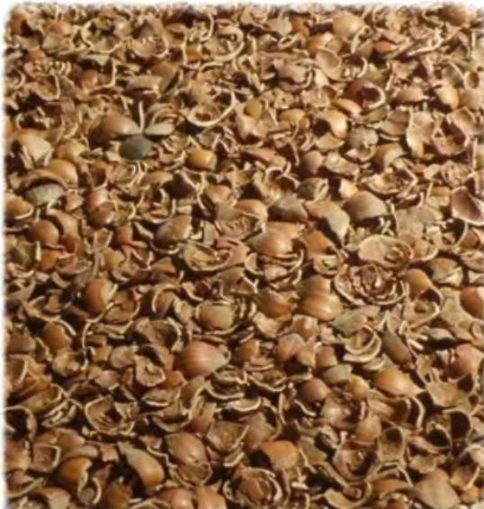
I gusci delle nocciole non subiscono alcun trattamento chimico ma esclusivamente meccanico. Hanno un potere calorifico di circa 4,2 kWh/kg (15,12 MJ/kg), un tenore idrico sempre sotto il 10%, una densità apparente che varia tra i 360 kg per metro cubo in caso di gusci di nocciole spaccate a metà fino a 430 kg a metro cubo per i gusci di nocciole macinati.
