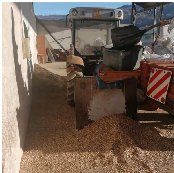
Il 14/12/2021 è stato dato l'avvio alla produzione di circa 7 - 10 mc di mattoni, di dimensione 12 x 20 x 50 cm, con l'utilizzo della linea produttiva MASA. È stata impiegata la ricetta "1 bis", con un aumento della calce nell'impasto ai fini di un'inertizzazione della parte organica. Ecco la composizione finale della miscela (a mc):
