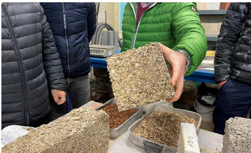
I primi test effettuati confermano la possibilità di eseguire delle prove in macchina. I vari inerti utilizzati si amalgamano tra di loro e con i leganti utilizzati, oltre che alla terra cruda, ed è possibile utilizzare leganti sia a base cementizia che a base calce.
